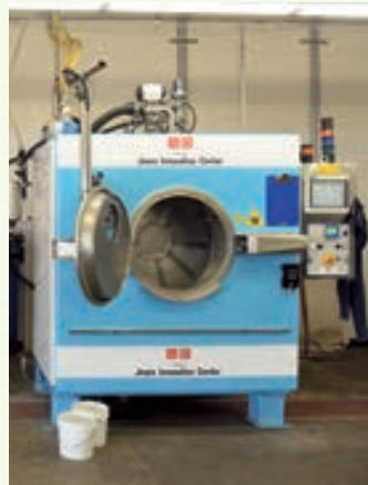
JIC研究開發的水洗設備
