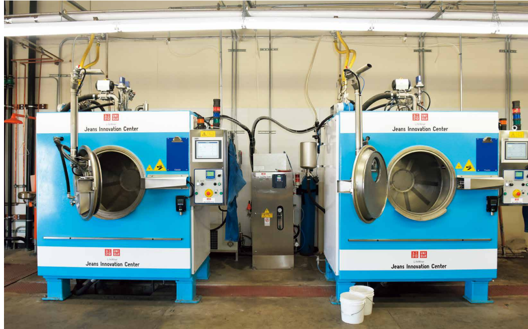
ジーンズのウォッシュ加工における水使用量を削減するウォッシュマシン
