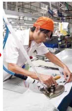
认真仔细地进行熨烫、打包操作。设置多道检验工序，对产品质量及安全进行严格把关。
