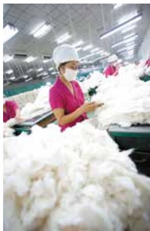
棉纺流程从松解原棉开始，需经过10道工序。为获得稳定的品质，采用不同产地的原棉进行混纺。
