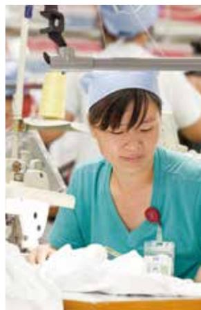
缝制工艺从裁剪和机械缝合开始，机械缝合要求工人在细心操作的同时，还要具备足够的耐心。
