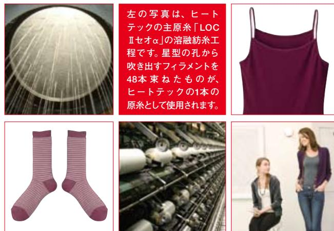
左の写真は、ヒートテックの主原糸「LOCⅡセオα」の溶融紡糸工程です。星型の孔から吹き出すフィラメントを48本束ねたものが、ヒートテックの1本の原糸として使用されます。
