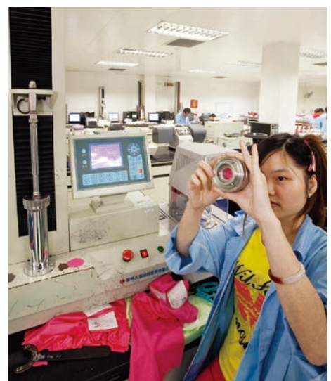
染色後の布地の強度を計測・検査しています。
