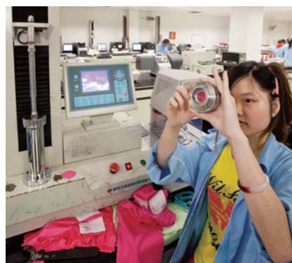
染色後の布地の強度を計測・検査しています。
