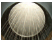
星型の孔から吹き出す「LOC IIセオα」のフィラメント。48本束ねたものがヒートテックの1本の原糸として使用されます。
