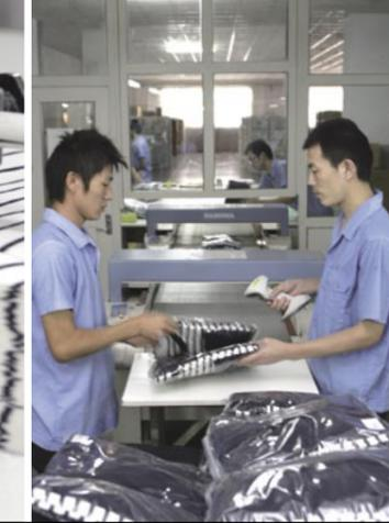
染色前後と裁断前に、発光するボードの上で傷、穴等の不具合を全量検査
