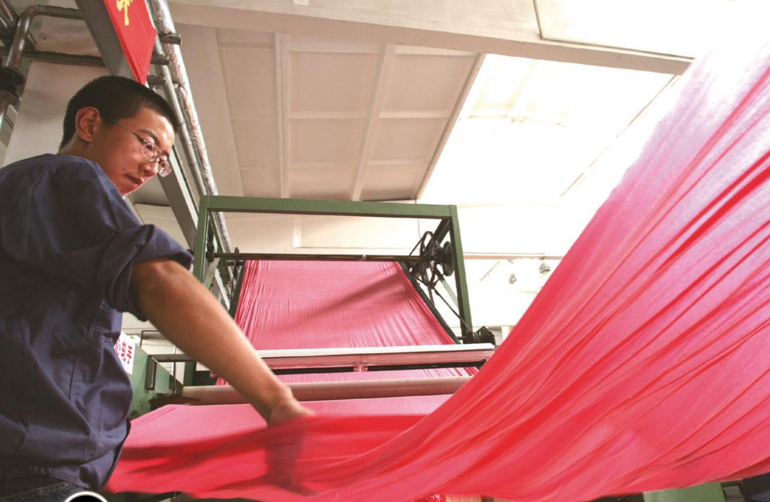
Toutes les matières tissées sont contrôlées pour détecter des égratignures ou des trous avant et après la teinture et avant la coupe.
