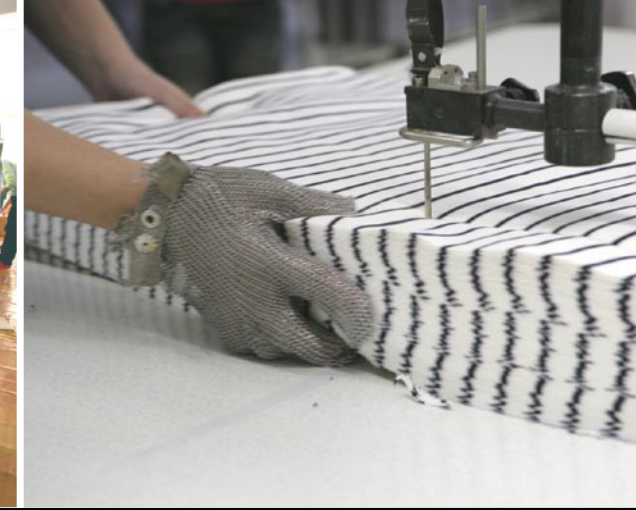
Le port de gants en métal est obligatoire lors de la coupe d'un tissu pour la sécurité des employés.
