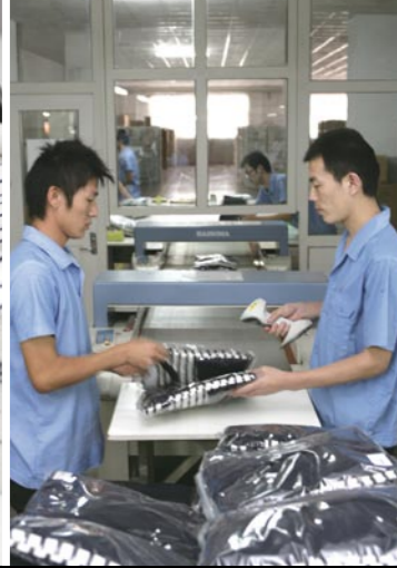
Détection d'aiguilles bidirectionnelles (vertical et horizontal).
