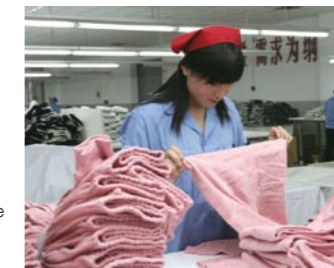
Des produits sont étirés lors de contrôles par échantillonnage suite au signalement par un client d'un rétrécissement.
