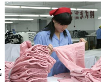
顾客希望知道产品的缩水状况，为此，在抽样检查时进行实际拉伸确认。
