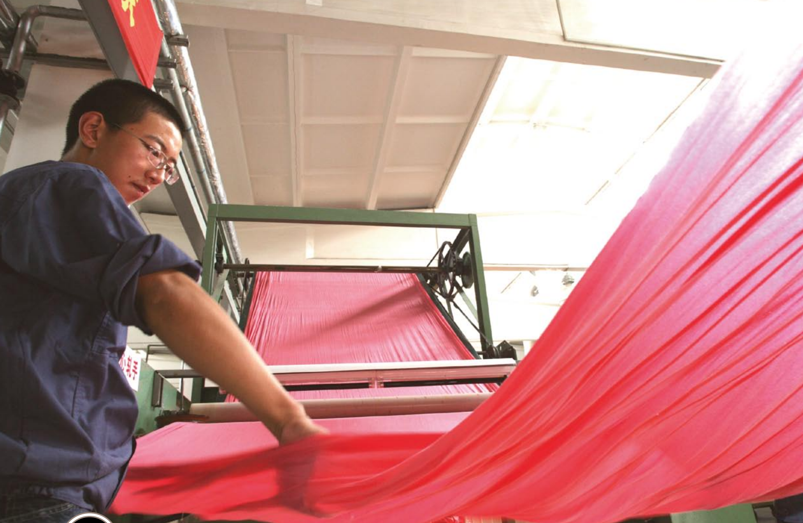
染色前后与裁剪前，在发光板上对所有布料进行有否损伤、孔眼等的状态检查。
