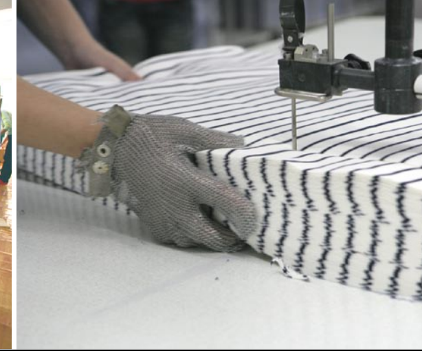
为了员工的安全，规定裁剪时必须戴上金属手套。
