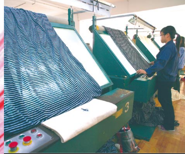
染色前后与裁剪前，在发光板上对所有布料进行有否损伤、孔眼等的状态检查。
